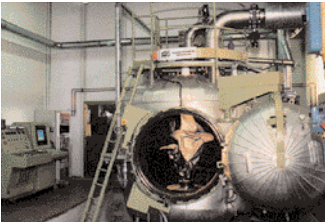
Figura 1 - A sinistra: impianto Caps (Controlled atmosphere plasma spray) realizzato in collaborazione con l'Università di Roma "La Sapienza"; a destra: un esempio di riporto ceramico a grano fine.
