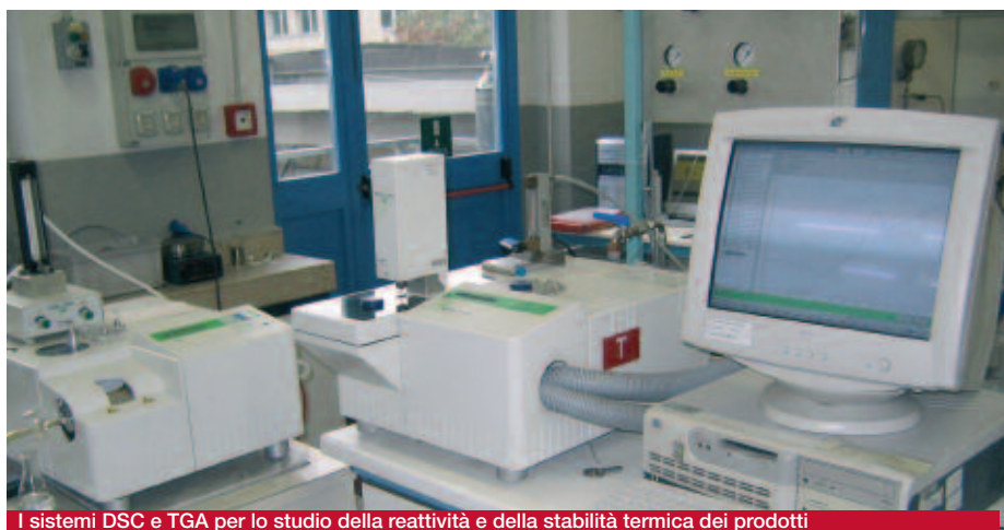
I sistemi DSC e TGA per lo studio della reattività e della stabilità termica dei prodotti
