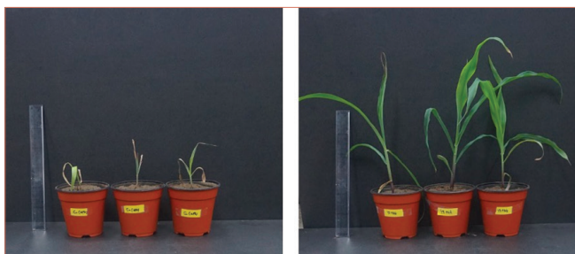
Fig. 3 - Test in serra su piante di mais cresciute in vaso in suolo salino. A sinistra, piante cresciute in presenza di "perfosfato triplo". A destra, piante cresciute in presenza del fertilizzante a base di fosfato di calcio sviluppato all'ISTEC-CNR
